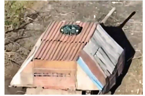
Ein russischer Schildkrötenpanzer mit integrierten Störsystemen rollt auf einem Feldweg. Bild: Army Recognition
