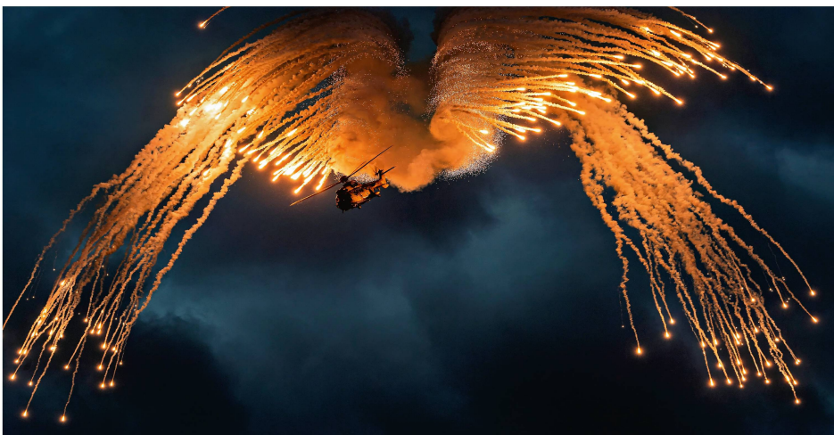
Ein Super Puma stösst Infrarot-Tauschkörper, sogenannte Flares, aus. Bild: Sina Guntern, VBS
