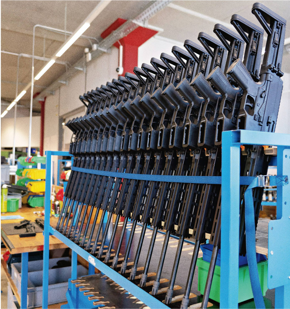
Eine Charge APC308 Pro DMR wartet nach der Endmontage auf den Funktionsbeschuss. Bild: B&T AG
