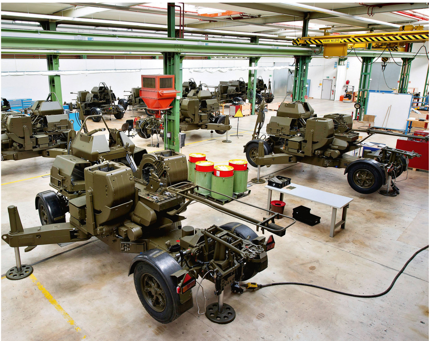
Fabrikation und Montage der Oerlikon-Zwillingsgeschütze im Werk 2. Bild: Rheinmetall Air Defence AG
