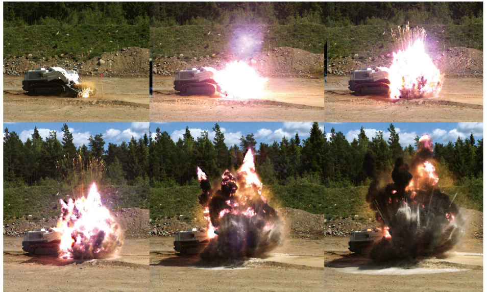
Leistungs- und Widerstandstest einer Digger-Maschine mit der schwedischen Armee, hier gegen eine Panzerabwehrmine mit einem Acht-Kilo-TNT-Äquivalent. Bild: Digger Foundation
