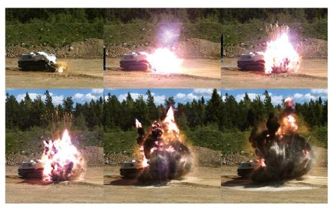
Leistungs- und Widerstandstest einer Digger-Maschine mit der schwedischen Armee, hier gegen eine Panzerabwehrmine mit einem Acht-Kilo-TNT-Äquivalent. Bild: Digger Foundation
