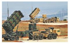
Die Mischung macht es aus: Hier sind vorne eine Werfereinheit in der Konfiguration PAC-3 sowie im Hintergrund ein Werfer mit PAC-2 der US Army zu sehen. Bild: PD
