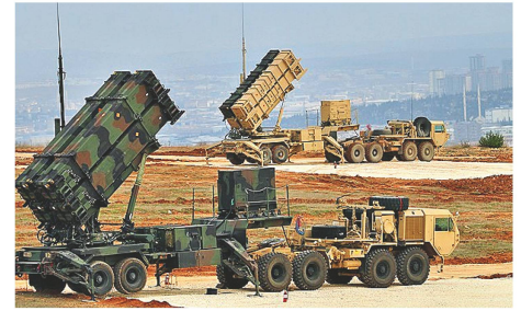
Die Mischung macht es aus: Hier sind vorne eine Werfereinheit in der Konfiguration PAC-3 sowie im Hintergrund ein Werfer mit PAC-2 der US Army zu sehen. Bild: PD
