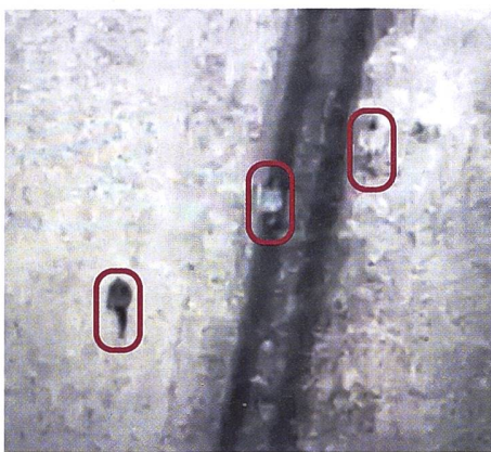
Wärmebildaufnahme einer Drohne von einer Person im aktuellen Schweizer Tarnanzug (links) und zwei Personen in Tarnanzügen von SSZ (Mitte und rechts).
