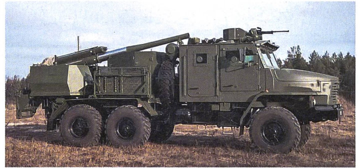
▲ Der neue Selbstfahrminenwerfer 120mm Phlox wurde erstmals in der Ukraine festgestellt. Bild: russisches Verteidigungsministerium
