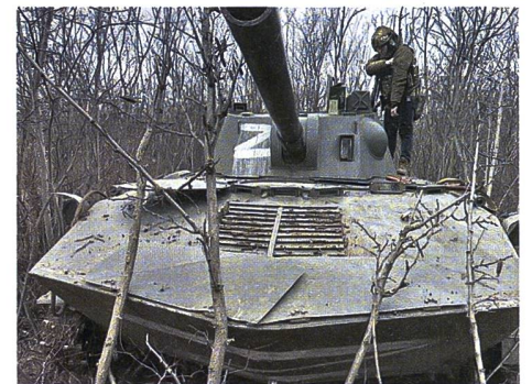
▲ Russland verstärkt seine taktische Artillerie mit mobilen Mörsern 120mm 2S9 Nona-S. Bild: Iswestija
