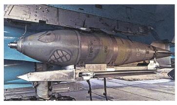
Vermehrt werden solche improvisierten Gleitbomben FAB-500 eingesetzt, die es dem Trägerflugzeug ermöglichen – hier eine SU-34 –, ausserhalb des Gefahrenbereichs der gegnerischen Flugabwehr zu agieren. Bild: thedrive
