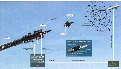
dem unteren und mittleren Luftraum her. Dies mittels einer speziellen Munition für seine Maschinenkanone, die unmittelbar vor Auftreffen auf das fliegende Ziel einen Hagel von Wolframkügelchen erzeugt. Damit bekämpft sie die Drohne wie mit einem Schuss aus einer Schrotflinte (siehe Schema).
