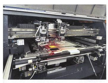
■ Elektrisches Prüfen hochspezialisierter Leiterplatten.
