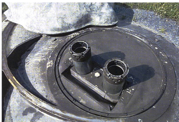
▲ Der 12-cm-Festungsminenwerfer, gut platziert und fähig intelligente Munition zu verschiessen, Beispiel unsinniger Sparmassnahmen; gelingt eine teilweise Reaktivierung?
