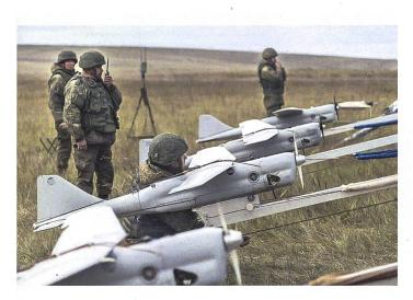
■ Die Drohnen Orlan-10 werden auch mit Störsendern Leer-3 eingesetzt. Bild: russian min. of defense
