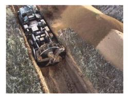
In der Nähe der Kleinstadt Hirske erstellen Wagner-Truppen einen mehrstufigen Verteidigungswall. Zum Bau der tiefen Gräben kommt auch eine Pioniermaschine vom Typ MDK-3 aus der Sowjet-Ära zum Einsatz. Bild: Screenshot Riafan
