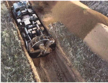
In der Nähe der Kleinstadt Hirske erstellen Wagner-Truppen einen mehrstufigen Verteidigungswall. Zum Bau der tiefen Gräben kommt auch eine Pioniermaschine vom Typ MDK-3 aus der Sowjet-Ära zum Einsatz. Bild: Screenshot Riafan
