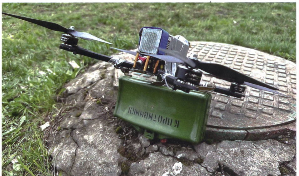
▼ Sprengmittel jeglicher Art, hier am Beispiel einer zwei Kilogramm schweren Antipersonenmine vom Typ MON-50, werden unter die Kleinstdrohnen montiert.
