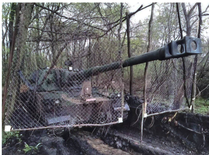
◀ Passiver und improvisierter Schutz, hier am Beispiel einer ukrainischen Panzerhaubitze vom Typ «Krab». Solche einfachen Schutzmassnahmen erweisen sich gegen Drohnen wie auch «Loitering Attack Munitions» als wirksam.
