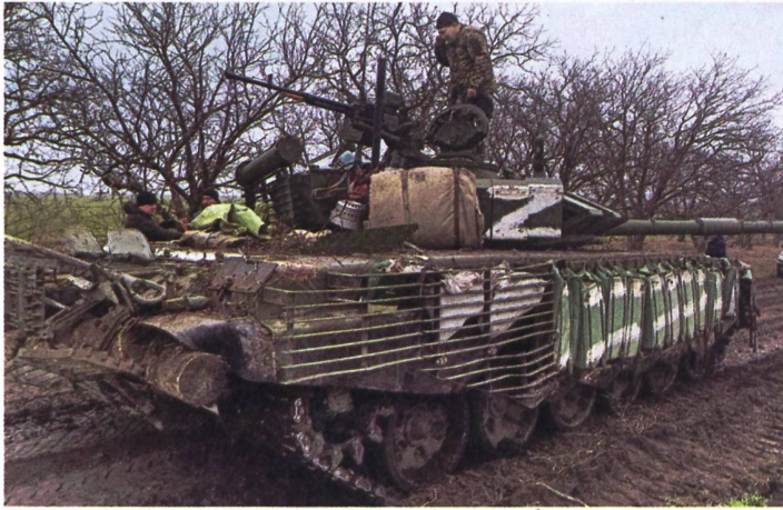
Der Kampfpanzer T-72B4 verfügt über seitliche Zusatzpanzerungen.
