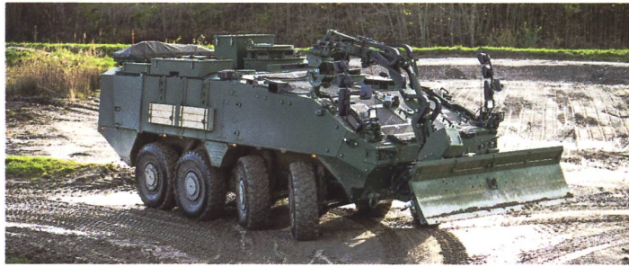
Solche Panzersappeur-Fahrzeuge Piranha IV, ausgerüstet in der Konfiguration Greifarm, werden zusätzlich beschafft. Bild: Clemens Laub, VBS
