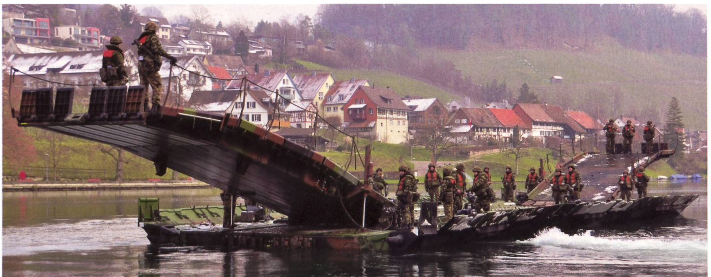
▼ Die Fähre mit einer Tragkraft von 65 Tonnen der Pont Kp 26/2 ist bereit für die Fahrt über den Rhein bei Eglisau. Bild: Ernesto Kägi.
