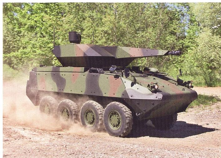
◀ Noch ein Technologieträger der Zukunft: Das Oerlikon Skyranger 35mm-Mobile Air Defence System auf Piranha-Fahrgestell.
