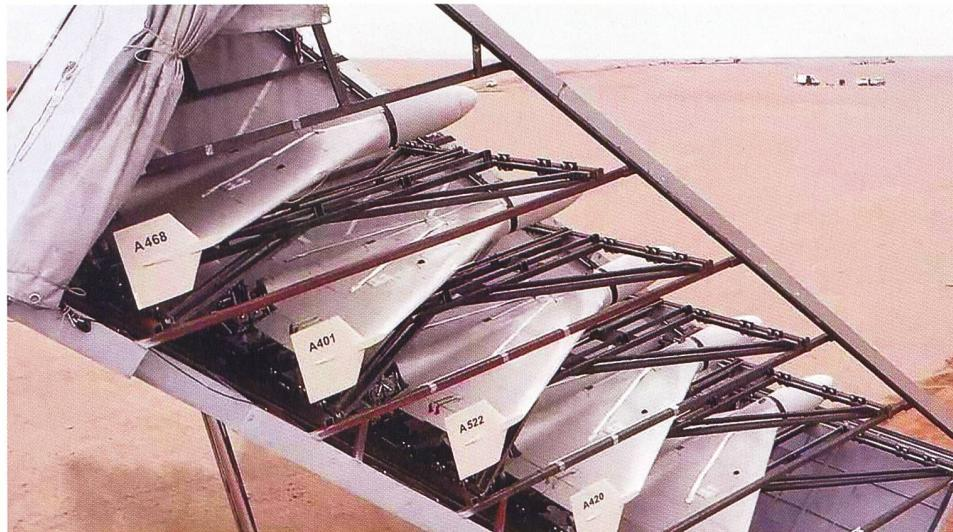
► Hohe Mobilität: Shahed-136 – in Russland Geran-2 genannt – lassen sich in Salven von fünf abfeuern, hier auf Basis eines Lastwagens. Geschätzte Reichweite bei 185 km/h: 2400 km.
