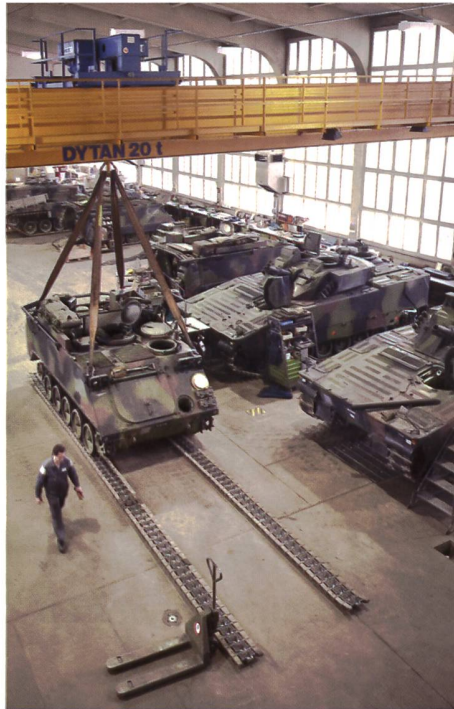
Ein Schützenpanzer hängt am Deckenlaufkran in der Panzer-Werkstatthalle des Logistikcenters Hinwil.
