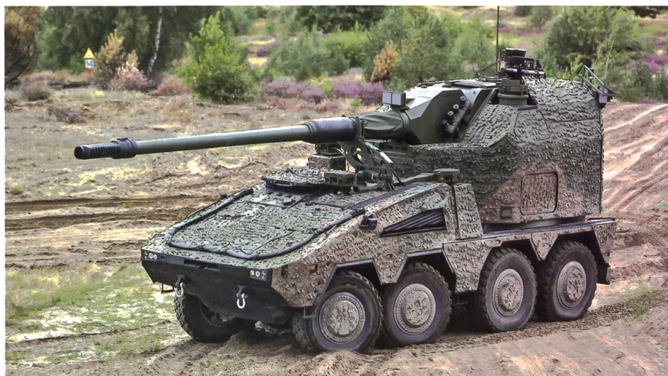
▼ RC155 von Krauss-Maffei Wegmann aus Deutschland mit einem Boxer-Fahrgestell.
