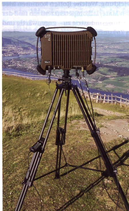
22-09 TRC4100, vollständig bei Thales Suisse entwickeltes leistungsfähiges Breitbandkommunikationssystem. Bilder: Thales Suisse SA
