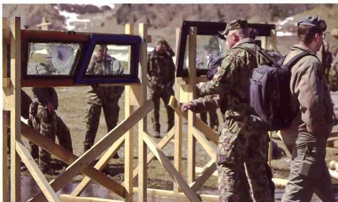
◀ Panzerglas: Die Scheiben des Mowag Eagle haben Gewehr- und Artilleriekugeln verschiedener Kaliber abgehalten.
