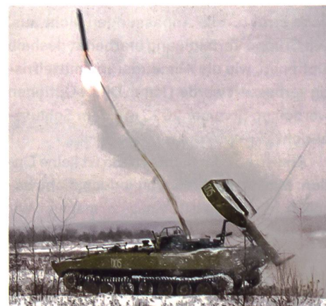
▲ Minenräumsystem UR-77 beim Abschuss explosiver Räum-schlangen. Bild: Autor
