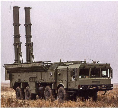
Raketensystem Iskander-K mit zwei Abschusscontainern für den Einsatz von Marschflugkörpern.
