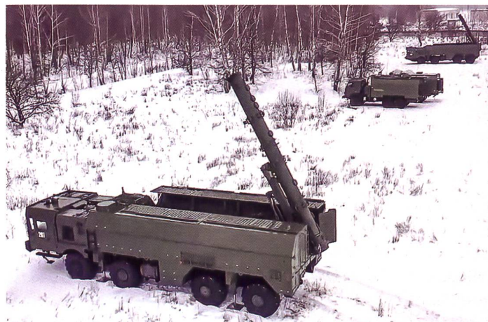
▶ Das Raketenystem Iskander-K verschießt Marschflugkörper 9M728. Das Waffensystem kann auch einen atomaren Gefechtskopf abfeuern. Bild: Russian MoD
