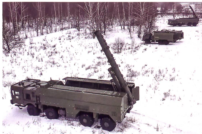
► Das Raketen system Iskander-K verschiebt Marschflugkörper 9M728. Das Waffen system kann auch einen atomaren Gefechtskopf abfeuern. Bild: Russian MoD
