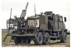
Selbstfahrminenwerfer 120 mm «Flox». Bild: Russland MoD
