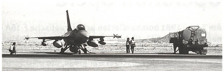
Kurz vor dem Start wird eine der F-16 nochmals betankt (Hot Refuelling).
