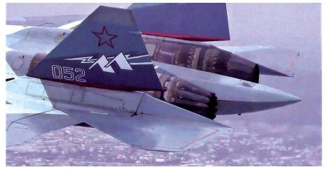
Die neuen Triebwerke beim Su-57 Stufe 2.
