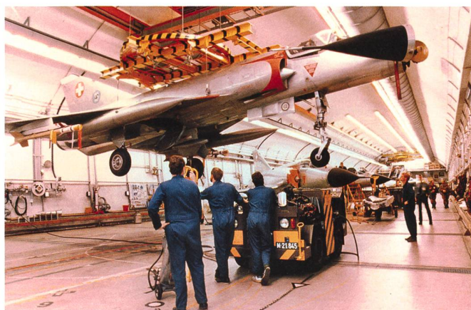
Krandrehmanöver in der Kaverne X; Mirage III S mit umgeklapptem Radom.
