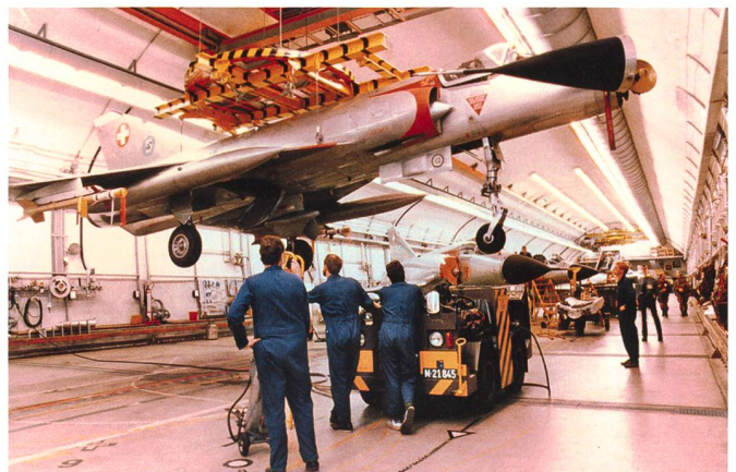
Krandrehmanöver in der Kaverne X; Mirage III S mit umgeklapptem Radom.
