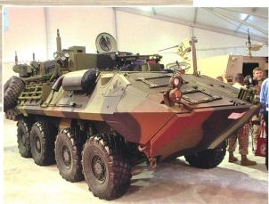
Achtrad LAV (Light Armoured Vehicles), basierend auf einem Mowag Produkt, gehören zur Standardausrüstung einer Marine Expeditionary Unit (MEU).
