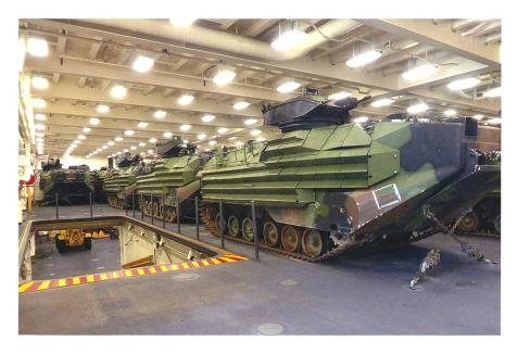
Schwimmpanzer des Typs AAV-7A1 des 2nd Assault Amphibious Battalions auf dem Docklandungsschiff USS Arlington (LPD-24).
