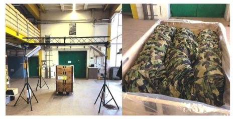
Lassen sich in einem Scannerportal innert Sekundenbruchteilen praktisch fehlerfrei erfassen: mit RFID-Transpondern ausgerüstete palettierte Textilien. Bilder: armasuisse W+T
