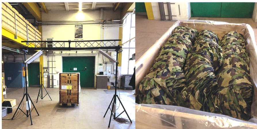
Lassen sich in einem Scannerportal innert Sekundenbruchteilen praktisch fehlerfrei erfassen: mit RFID-Transpondern ausgerüstete palettierte Textilien.
