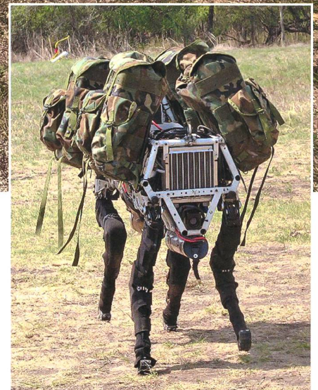
Mechanischer Lastesel «Big Dog» Boston Dynamics.
