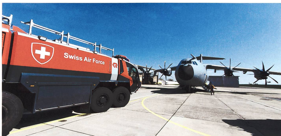
Alarmübung für das UP: Überhitzung am Hauptfahrwerk. Stellungsbezug TANGO, das heisst die Fahrzeuge stehen vor dem Flugzeug. Zur Brandvermeidung wird das Fahrwerk mit Ventilatoren gekühlt. Für den Notfall werden zwei Hohlstrahlrohre bereitgestellt. Bild: Maj Ruben Romero/VBS
