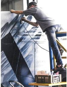
ge Abschleifen und Grundieren sowie die Lackierung zum Schluss durch Fachleute der RUAG vorgenommen. Das Zeitfenster für die Bemalung gibt die NSF vor, wie Wüst erklärt: «Der Termin wird parallel zu anderen Instandhaltungsarbeiten geplant. Kein Flugzeug wird extra stillgelegt, nur damit es bemalt werden kann.»
