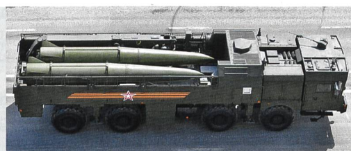
Nachladefahrzeug mit zwei Raketen 9M723 und abgesenktem Kranausleger.
