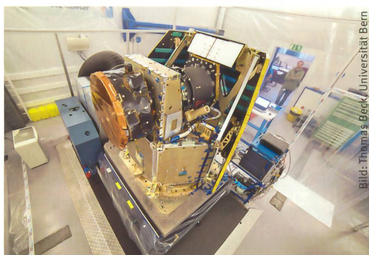
Das Teleskop von CHEOPS wurde in der Universität Bern entwickelt, zusammengebaut und getestet.
