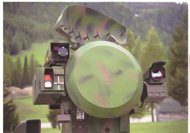
Die Sensoren des Flt Gt: Such- und Folgeradar sowie elektrooptische Kamera (EO) und Infrarot Kamera (IR). Bilder: VBS
