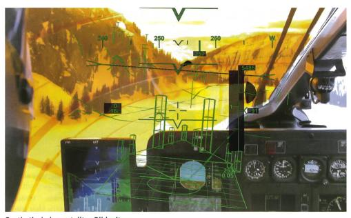
Synthetisch dargestelltes Bild mit dem SFERION-System im EC635 der Luftwaffe. Bilder: VBS
