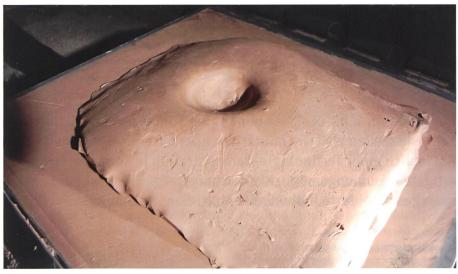
Verformung des Hintergrundmaterials (Plastilin = Simulation des menschlichen Körpers) nach Beschuss des Schutzpakets.
