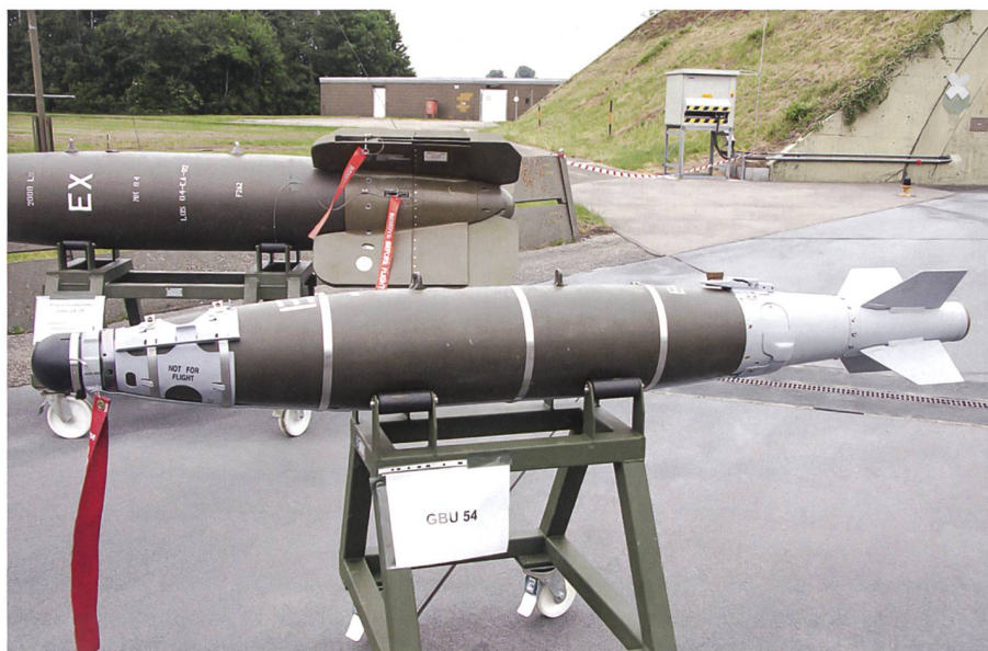
Moderne Präzisionsbombe GBU-54 mit Mehrfachlenkung (GPS/INS/Laser).
