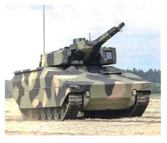
ausgestattet und verfügt als Hauptbewaffnung über eine stabilisierte fremdangetriebene und luftsprengpunktfähige Maschinenkanone wahlweise im Kaliber 30mm oder 35mm. Damit kann der Lynx Ziele mit hoher Präzision und Wirkung auf bis zu 3000 Meter bekämpfen – auch aus der Bewegung. Ebenso lassen sich Panzerabwehrlenkflugkörper und eine mit der Hauptoptik verbundene sekundäre Waffenstation (Main Sensor Slaved Armament/MSSA) einrüsten. Hierdurch verfügt der Lynx nicht nur über eine Hunter-Killer,
