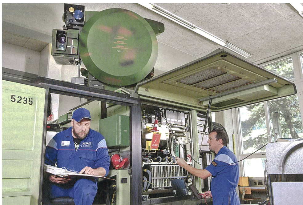
Hochspannungsmessung im Radarsender vom Skyguard des MFlab-Systems.
