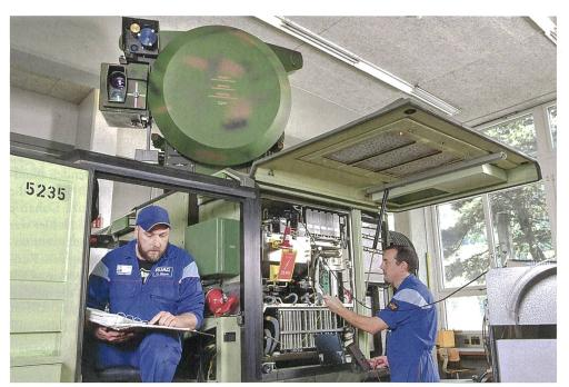
Hochspannungsmessung im Radarsender vom Skyguard des MFlab-Systems.
