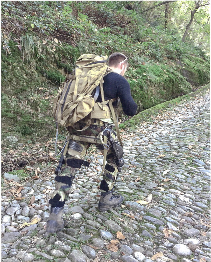
Testmarsch mit Exoskelett und Last.
