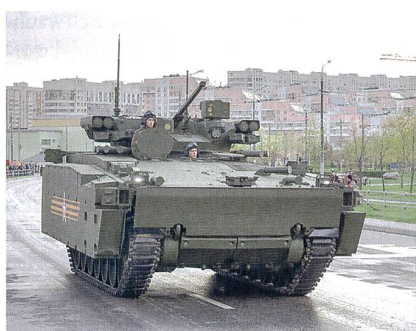
Verstärkter Seitenschutz beim Schützenpanzer «Kurganetz-25».
