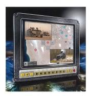
Dimmbereich individuelle Anpassungen zur Helligkeitsreduktion, dies ermöglicht die Bedienung mit Nachtsichtbrille. Im Tarnmodus emittiert das Gerät kein Licht, bleibt aber eingeschaltet und in Funktion.
