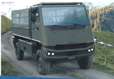
Neuer Aufbau mit Überrollschutz und 4-Punkt Gurtsystem
