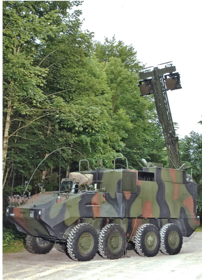
Radio Access Point (RAP) Panzer: Mosaikstein im IKT-System.
