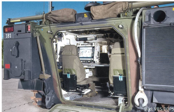
Ein mit FIS HEER ausgerüsteter Kommandoschützenpanzer 2000.
