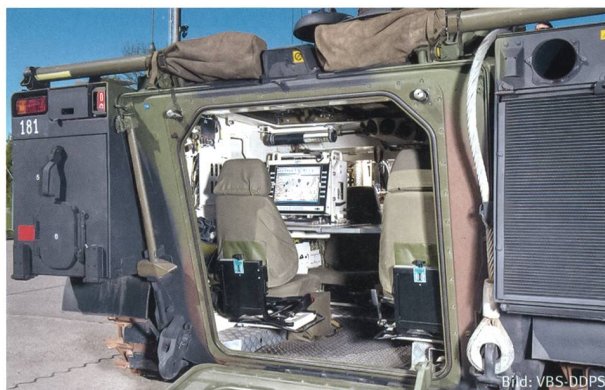
Ein mit FIS HEER ausgerüsteter Kommandoschützenpanzer 2000.
