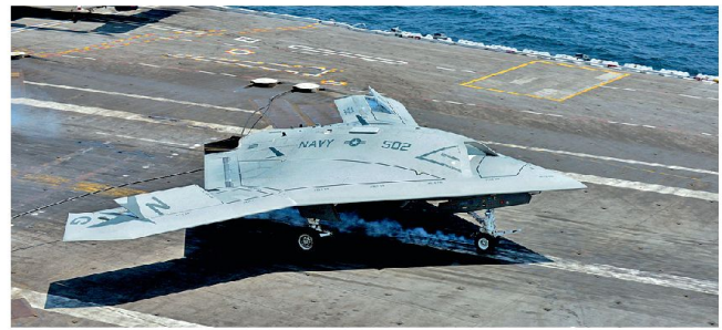
Das unbemannte Kampfflugzeug X-47B soll autonom von amerikanischen Flugzeugträgern operieren können. Bild: US Navy
