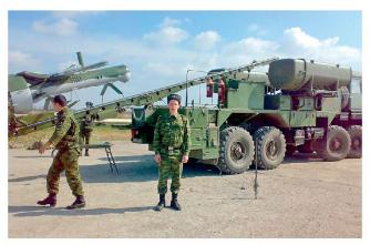
Einsatz veralteter Aufklärungsdrohnen (Bild: Drohnensystem «Shmel-1») bei den russischen Streitkräften. Bild: RR mil photos
