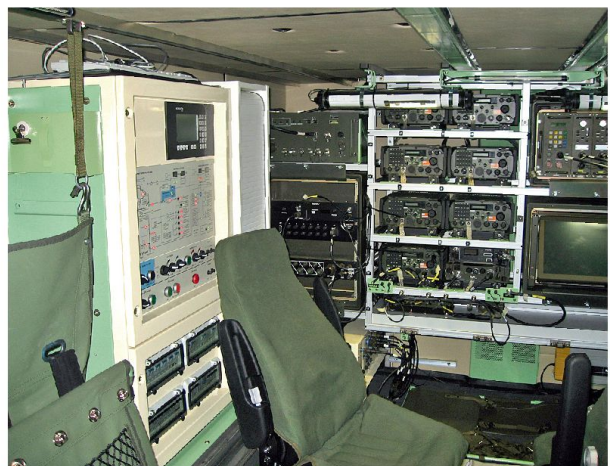
Innenansicht eines Radio Access Point Panzers (RAP Pz): Integration von Telekommunikationsausrüstung auf engstem Raum. Bild: Thales
