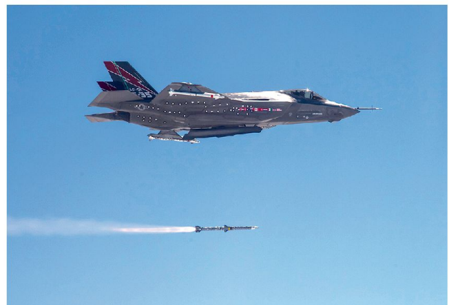
Moderne Kampfflugzeuge wie der F-35 sind künftig auch mit Boden-Luft-Lenk Waffen bewaffnet, die mit elektromagnetischen Gefechtsköpfen ausgerüstet sind.
